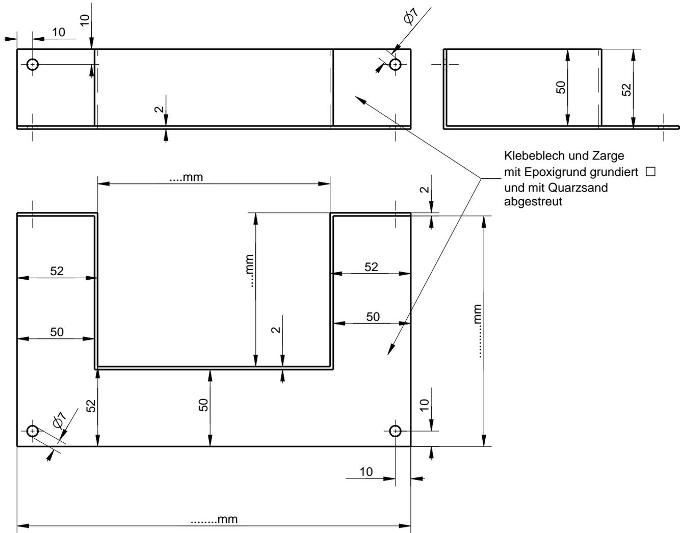
Kleblech und Zarge mit Epoxigrund grundiert und mit Quarzsand abgestreut
