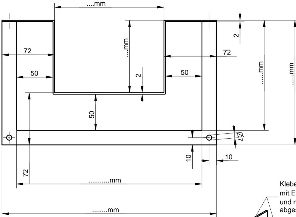
Klebebleche und Zarge mit Epoxigrund grundiert □ und mit Quarzsand abgestreut
