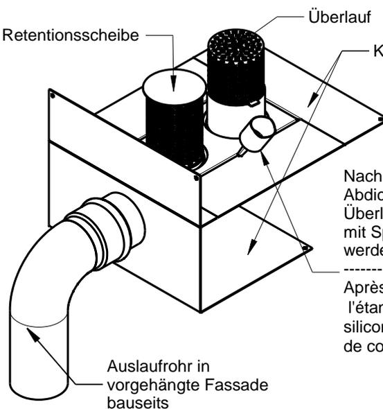
Nach dem Anschliessen der Abdichtungsfolie muss zwischen Überlaufhalter und Einlauftrand mit Spenglersilicon abgedichtet werden
