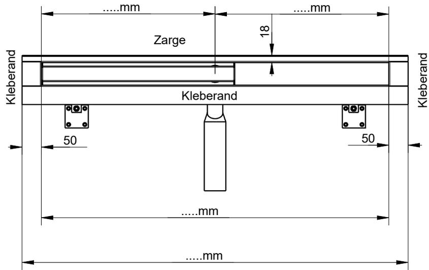
Kleberand und Zarge mit Epoxigrund grundiert und mit Quarzsand abgestreut
