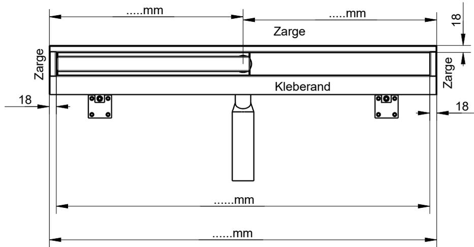
Kleberand und Zarge mit Epoxigrund grundiert und mit Quarzsand abgestreut
