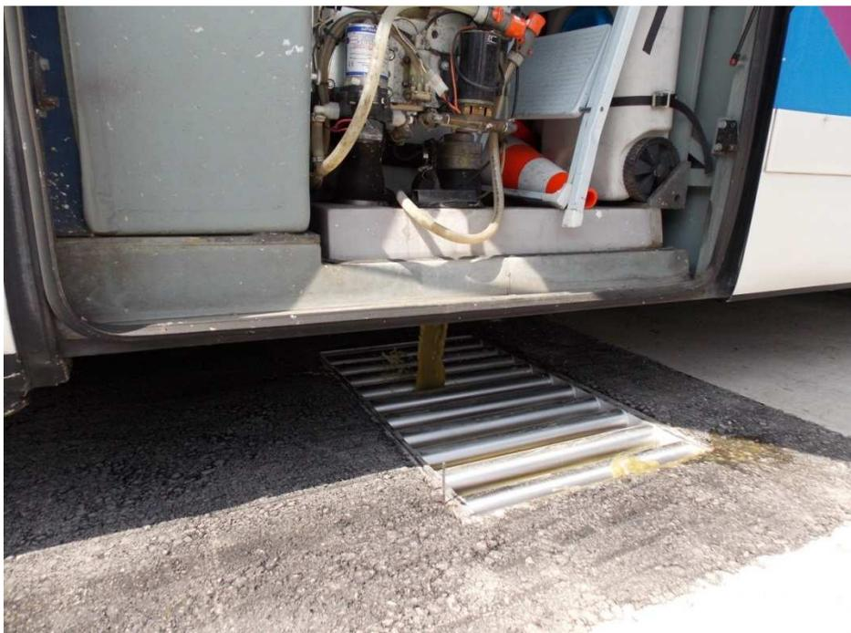
Tank spülen und Frischwassertank nachfüllen. Fertig
